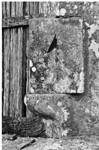
MOREIRA. Lugar, Pica. Situación, nunha hórrea, sobre unha ménsula, nun dos extremos. Forma rectangular; gnomon de chapa triangular. Tipo, vertical ortomeridiano orientado ó Sur. Estado de conservación regular. Propiedade, Sociedade de Sidra.
